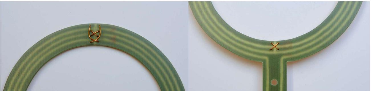
Die Bahnbrücken aus Kupferlackdraht wurden auf der Vorderseite der Loop-Antenne durch die Bohrlöcher gesteckt und auf der Rückseite mit den Kupferbahnen verlötet.
